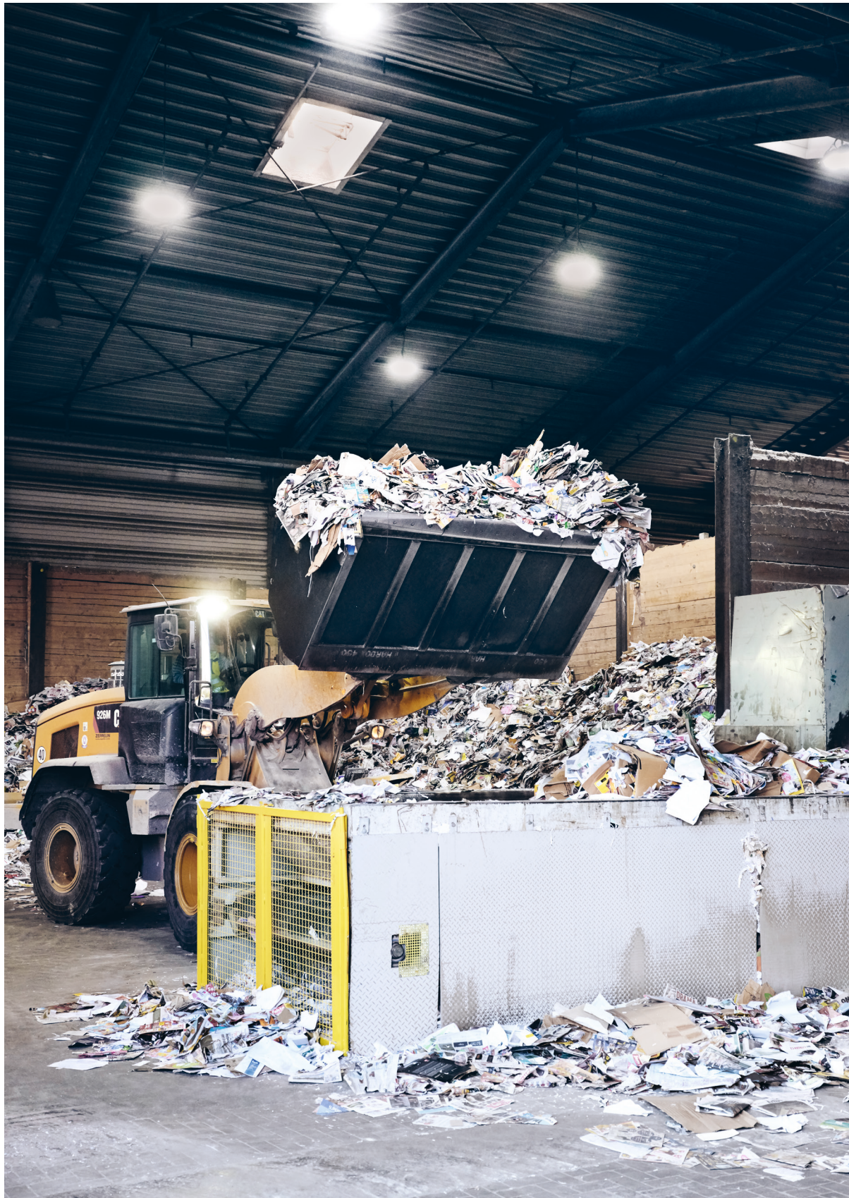
Altpapier aus haushaltnaher Sammlung wird in Buchten gelagert und in der Sortieranlage bei AP Concept für die Papierproduktion aufbereitet. Waste paper from household-related sources is stored in bays and prepared for paper production at AP Concept's sorting plant.
